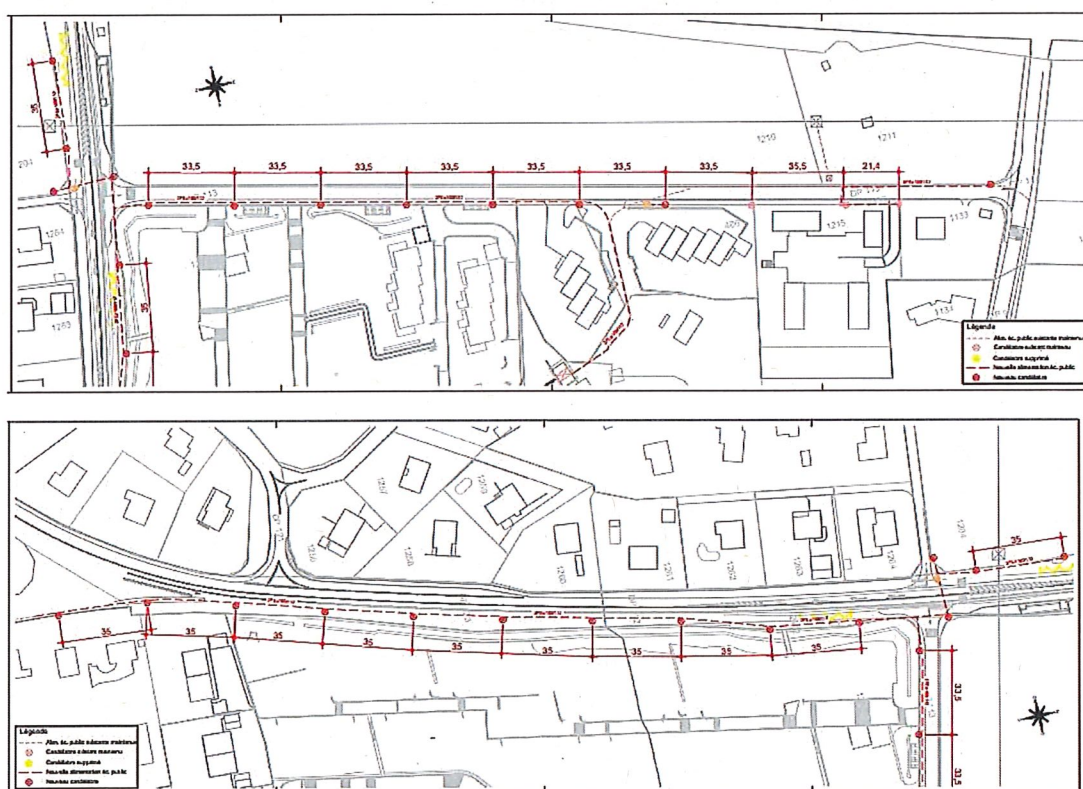
Figure : Extrait des plans de l'éclairage public projeté
